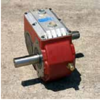
N/P 6811: Multiplicador M7 1:4 de la caja de engrajes
